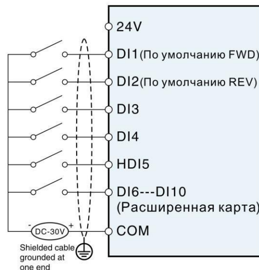
Рисунок 3-14 Диаграмма подключения к четырем различным режимам цифрового ввода
